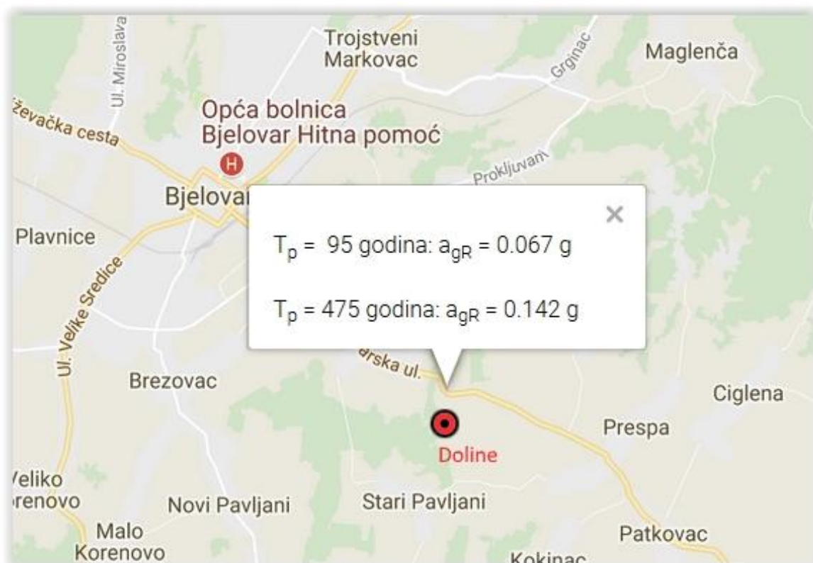
Slika 24. Vrijednost horizontalnih vršnih ubrzanja očekivanih na lokaciji sa Karte potresnih područja Republike Hrvatske (PMF, Sveučilište u Zagrebu) s iznosima horizontalnih vršnih ubrzanja tla tipa A( a_{gR} ) za povratna razdoblja od T_p=95 i 475 godina izraženih u jedinicama gravitacijskog ubrzanja ( 1g=9.81 \text{ m/s}^2 ) (www.seizkarta.gfz.hr).
